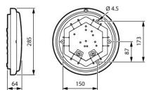
**Scheda tecnica Philips Bulkhead LED Ledinaire WL070V Bianca 20.9W 1700lm - 840 Bianco Freddo | 285mm - IP65 - Sensore di movimento e luce**
