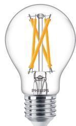
**Scheda tecnica Philips Classic LED Bulbo E27 Pera Filamento Chiara 7W 806lm - 922-927 Dim to Warm | Miglior resa cromatica - Dimmerabile - Sostitutiva 60W**
