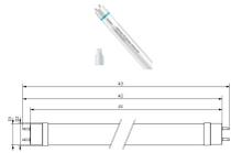
Scheda tecnica Philips Tubo LED T8 MASTER Value (EM/Mains) High Output 14W 2100lm - 865 Luce del Giorno | 120cm - Sostitutiva 36W
