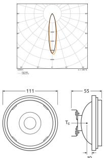
**Scheda tecnica Ledvance Parathom Pro LEDspot G53 AR111 7.4W 450lm 24D - 930 Luce Calda | Miglior resa cromatica - Dimmerabile - Sostituiva 50W**
