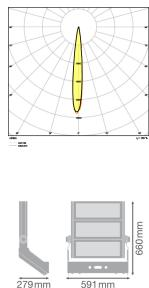
**Scheda tecnica Ledvance Proiettore LED MAX Grigio 900W 117000lm 10D - 757 Luce del Giorno | IP66 - Simmetrico**
